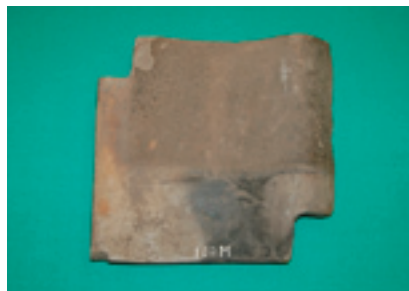
爆心地から約100mで発見された瓦 (上部にぶつぶつができています)
